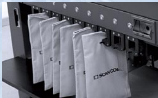
Sustitución de bolsas sin interrupción.
